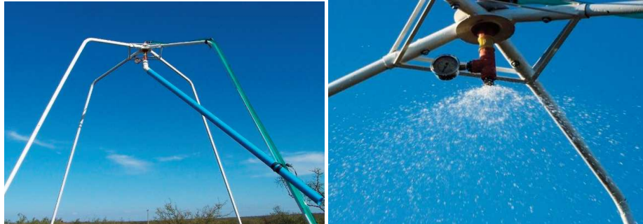
Figura 2. Estructura del simulador de lluvia con las cuatro patas extensibles y la posición del manómetro en la parte superior (izquierda). Simulador en funcionamiento, se observa la lluvia junto con el manómetro que indica la presión a la cual se midió la intensidad (derecha).
