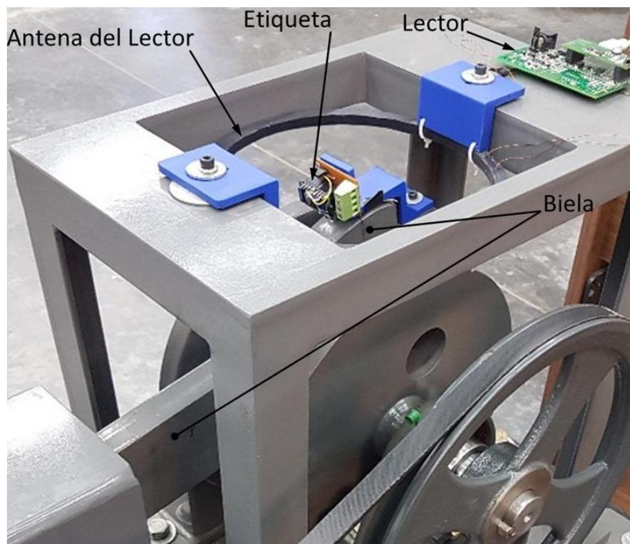
Sistema desarrollado en la Facultad de Ingeniería (UNLPam). Etiqueta embebida en la biela en movimiento transmite información de temperatura en cojinetes y recibe energía del lector estacionario
